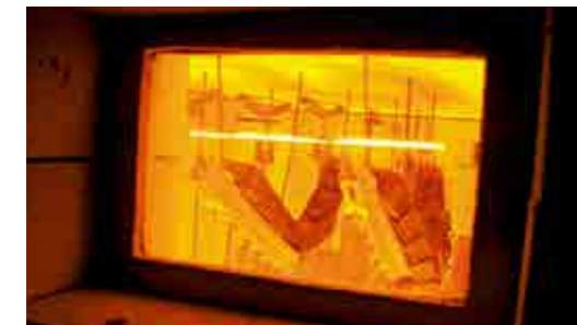
MQ 安装吊挂系统的耐火试验
