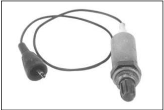
Figure 5B-11. Oxygen Sensor.
