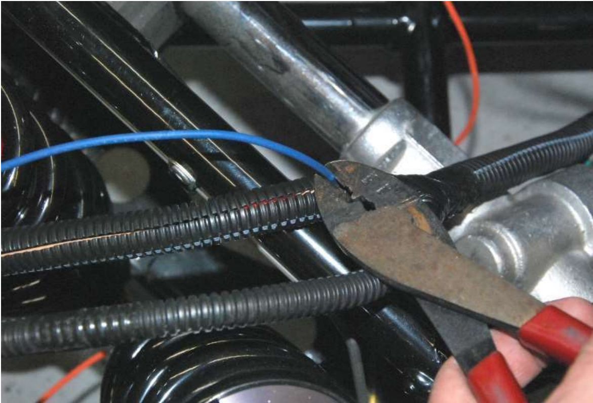
Cut the blue fan wire.
