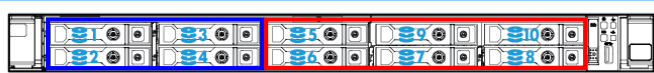
オプションの DL360 Gen9 6xNVMe Express ベイキット搭載時 4SFF + 6NVMe ドライブケース構成
