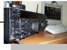
Il Mark-V ha una interfaccia CAT con standard seriale a livelli RS232 quindi non necessita di convertitori di livello o adattatori di bus.
