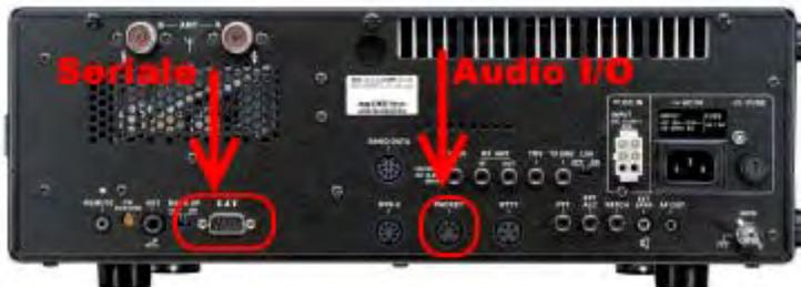
Oltre al semplice cavo seriale 9 pin – 9 pin per il CAT (dove servono solo i pin 2-3 e la massa sul 5, cablato pin to pin), per le modalità digitali sull'RTX FT-1000mp Mark-V conviene utilizzare la presa posteriore denominata PACKET.
