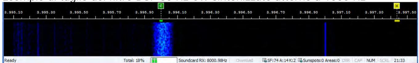
Esempio di taglio di filtro DSP 240 Hz sintonizzato attorno a 1000 Hz
