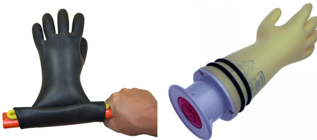
Slika 11. Način ispitivanja izolacijske rukavice napuhavanjem zrakom
