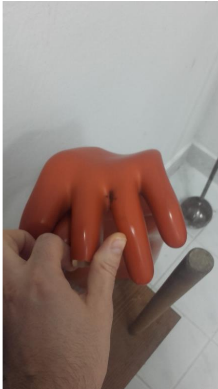
Slika 14. Mjesto proboja kompozitne izolacijske rukavice klase 3 pri dielektričkom ispitivanju (Izvor: HEP NOC)
