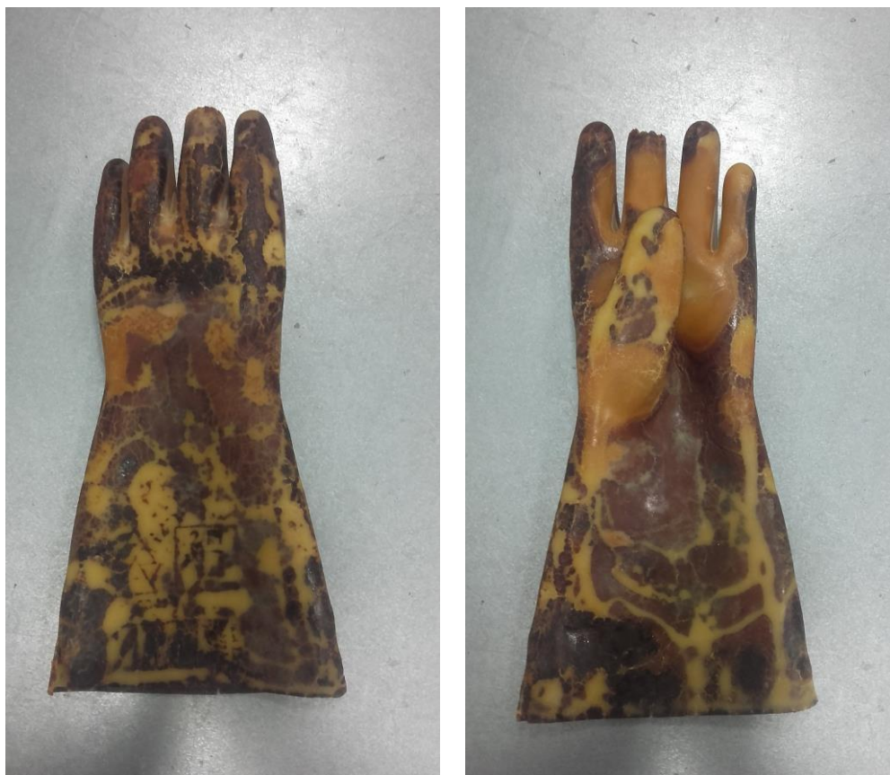
Slika 13. Oštećenja izolacijske rukavice klase 2 sunčevim svjetlom (Izvor: HEP NOC)
