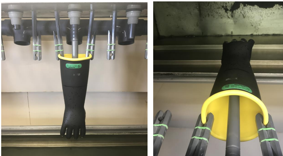
Slika 12. Način ispitivanja izolacijskih rukavica u KINECTRICS, Toronto (Izvor: Ana Lovrenčić)
