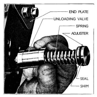
Fig. 185 Unloading Valve
