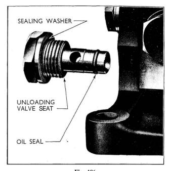
Fig. 186 Unloading Valve Seat
