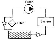
(d) Blocked filter protection and suction blocking
