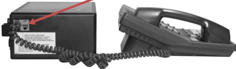
**FIGURE 18: RJ22 PORT ON RIGHT SIDE OF ICRI**
