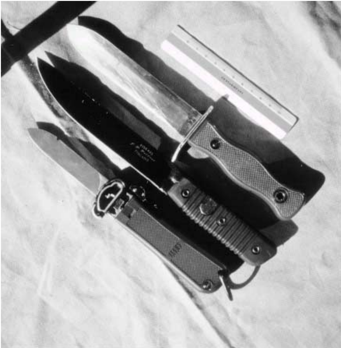
Abbildung 3.14: Militärmesser. Von oben: Bundeswehirkampfmesser alter Typ (Bundeswehr oder Herbertz), Klinge: DIN X45CROV15, Griff: Kunststoff. Finnisches Sissipuuikko (Fiskars), Klinge: Carbonstahl, Griff: Gummi. BW Fallschirmjägersmesser (hier Fallmesser mit einer kürzeren, zivil zugelassenen Klinge). Sammlung: Lüddecke
