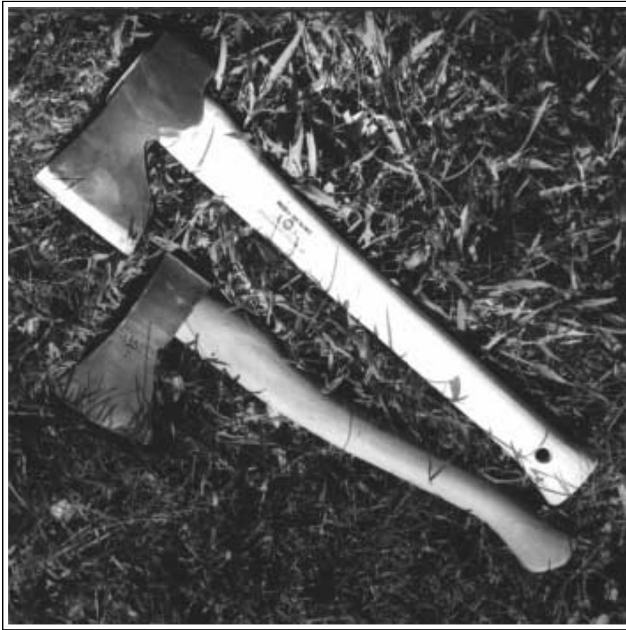
Abbildung 2.16: oben Tischlerbeil, handgeschmiedet von Lennart Petterson, Gränsfors Bruk. Unten altes Forstbeil mit neuem Schaft. Sammlung Lüddecke.
