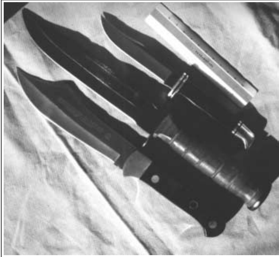
Abbildung 2.3: Bowiemesser. Von oben: Buck Woodman, Klinge: 425M, Beschläge: Dural, Griff: Ebonit. Kampfmesser US Marine Corps, Griff: Lederscheiben. Puma-Werke Johann Wilhelm Lauterjung seit 1769 (Puma) 6030 Alaskan, Klinge: New Stainless keen cutting steel (was auch immer sich hinter dieser Herstellerbezeichnung verbirgt), Beschläge: Messing, Griff: Holz. Sammlung: Lüddecke
