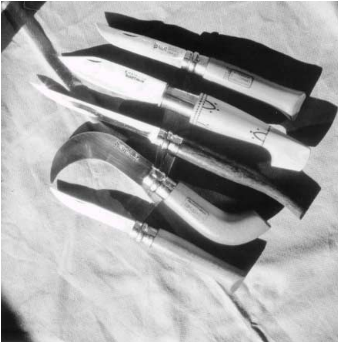
Abbildung 3.16: Klappmesser (Opinel). Von oben: Opinel No.8, Klinge: Carbonstahl, Griff: Buchenholz. Nontron Catalane, Klinge: Carbonstahl, Griff: Buchsbaumholz. Opinel Fischfiliermesser No.8, Klinge: rostfreier Federstahl, Griff: gebeiztes Hartholz. Opinel Hippe, Klinge: Carbonstahl, Griff: Buchenholz. Opinel No.8, Klinge: Inox, Griff: Buchenholz. Sammlung: Lüddecke
