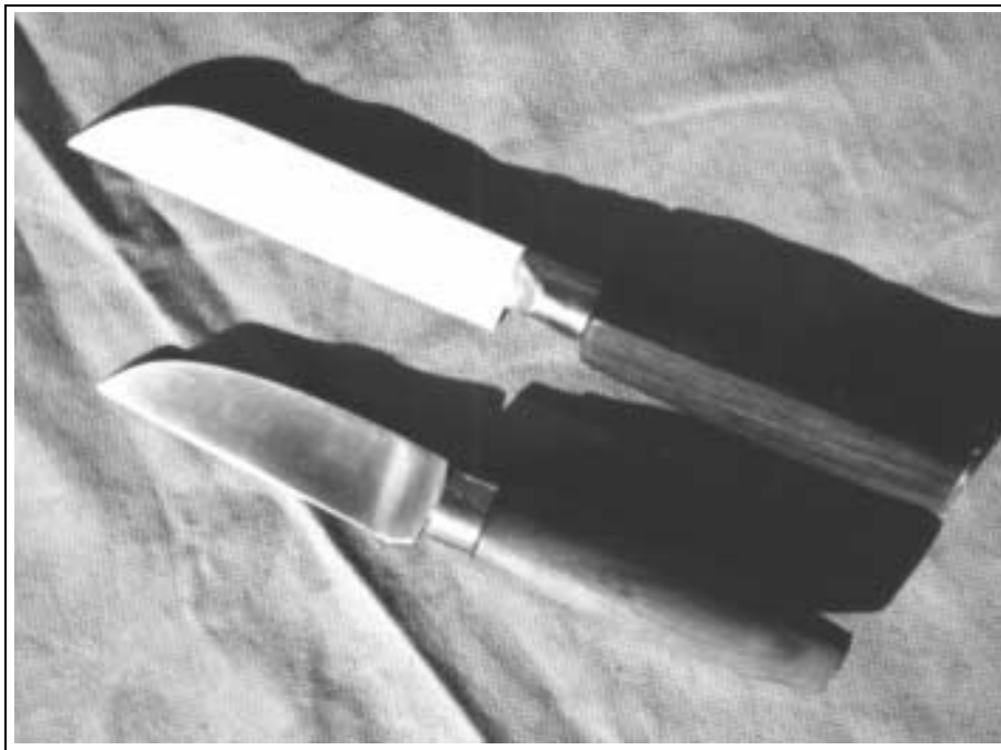
Abbildung 2.9: Scherper. Von oben: Burgvogel Scherper, Klinge: Rostfrei, Griff: Palisander. Scherper, Klinge: Carbonstahl, Griff: Buchenholz. Sammlung Lüddecke
