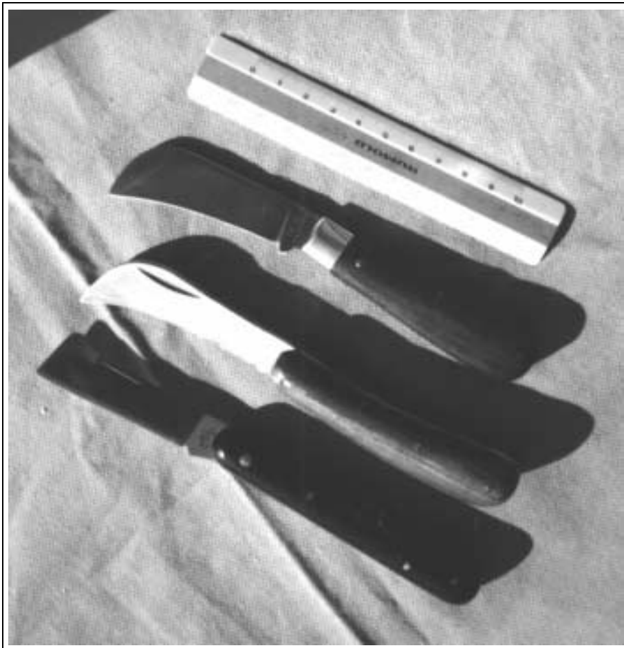
Abbildung 2.5: Zwei Hippen und ein Okuliermesser als Klappmesser (von oben: Rogers seit 1682, Stahl: Carbon, handgeschmiedet, Griffschalen: Palisander. Herbertz Gärtnermesser, Stahl: rostfrei, Griffschalen: Holz. Herbertz Comè, Griff: Kunststoff). Sammlung: Lüddecke
