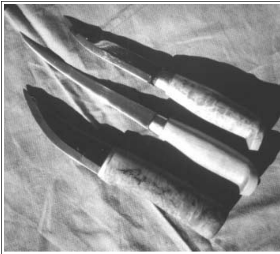
Abbildung 2.7: Puukko. Von oben: Martiini Puukko, Klinge: Inox, Griff: Birkenholz. Martiini Fischmesser (Filettierklinge), Klinge: Inox, Griff: Birkenholz. Haimo Roselli Puukko, Klinge: Carbonstahl, handgeschmiedet, Griff: Birkenholz geölt. Sammlung: Lüddecke
