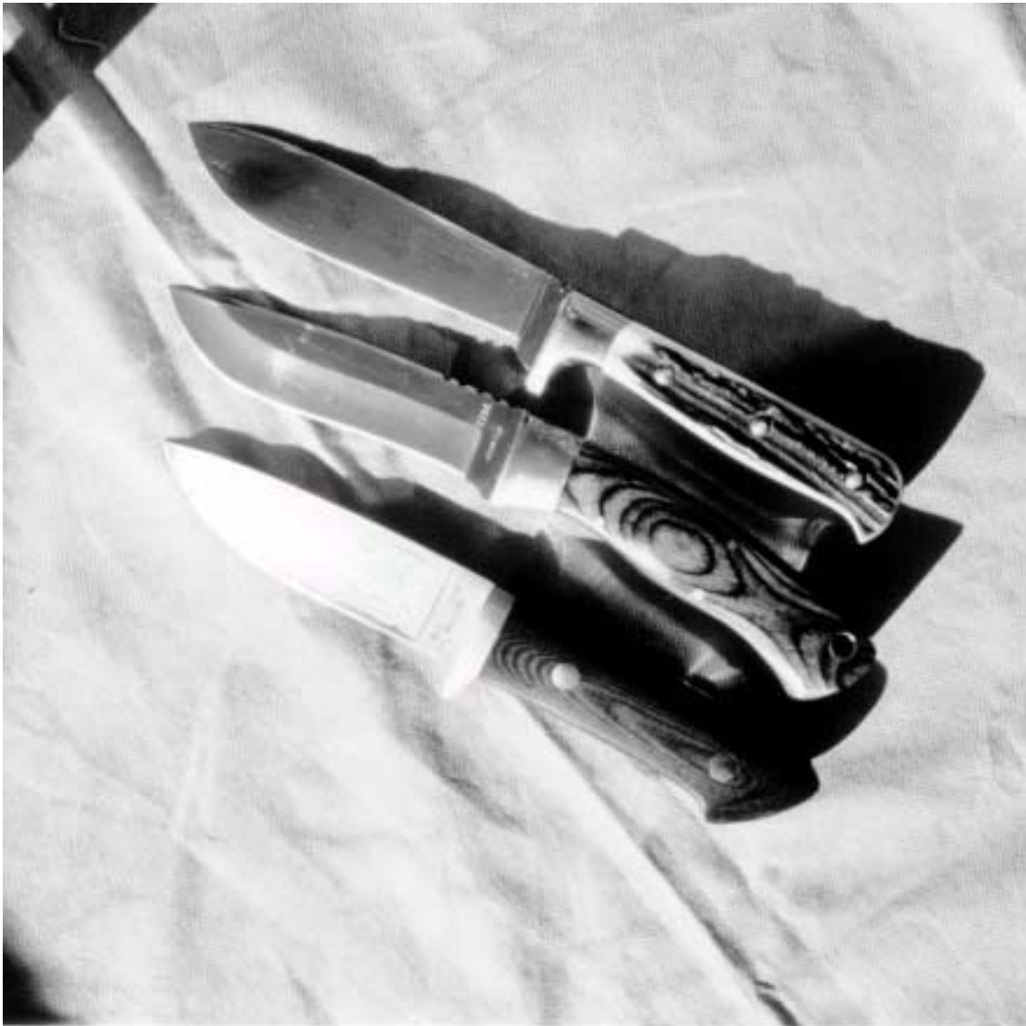
Abbildung 3.13: Jagdmesser. Von oben: Puma Jagdnicker nach Frevert, Klinge: Inox, gesenkgeschmiedet, Beschläge: Neusilber, Griff: Hirschhorn. Schlieper Outdoor Classic, Klinge: Stainless, Beschläge: Neusilber, Griff: Schichtholz. Herbertz, Klinge: Damast 17 Lagen, Beschläge: Neusilber, Griff: Moosmikata. Sammlung: Lüddecke
