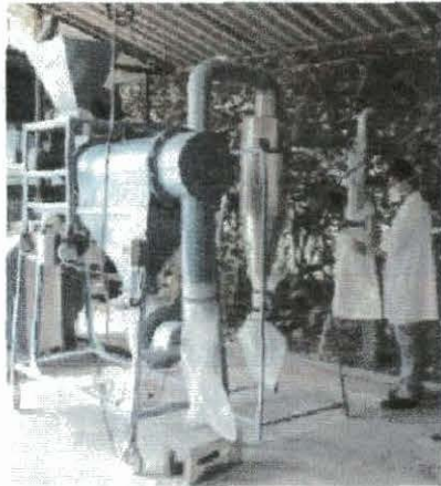
Figura 1.1. Planta piloto modular para la producción de harina de yuca (instalaciones de Clayuca)
