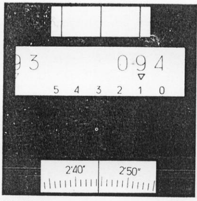
Pembacaan koinsidensi lingkaran horizontal dan lingkaran vertikal berskala pada teodolit unversil Wild T12
