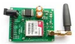
figure4(c) GSM module
