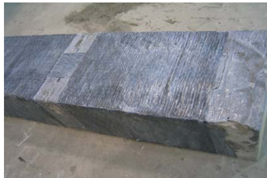
(d) Debonding of CFRP with wrap (beam10)
