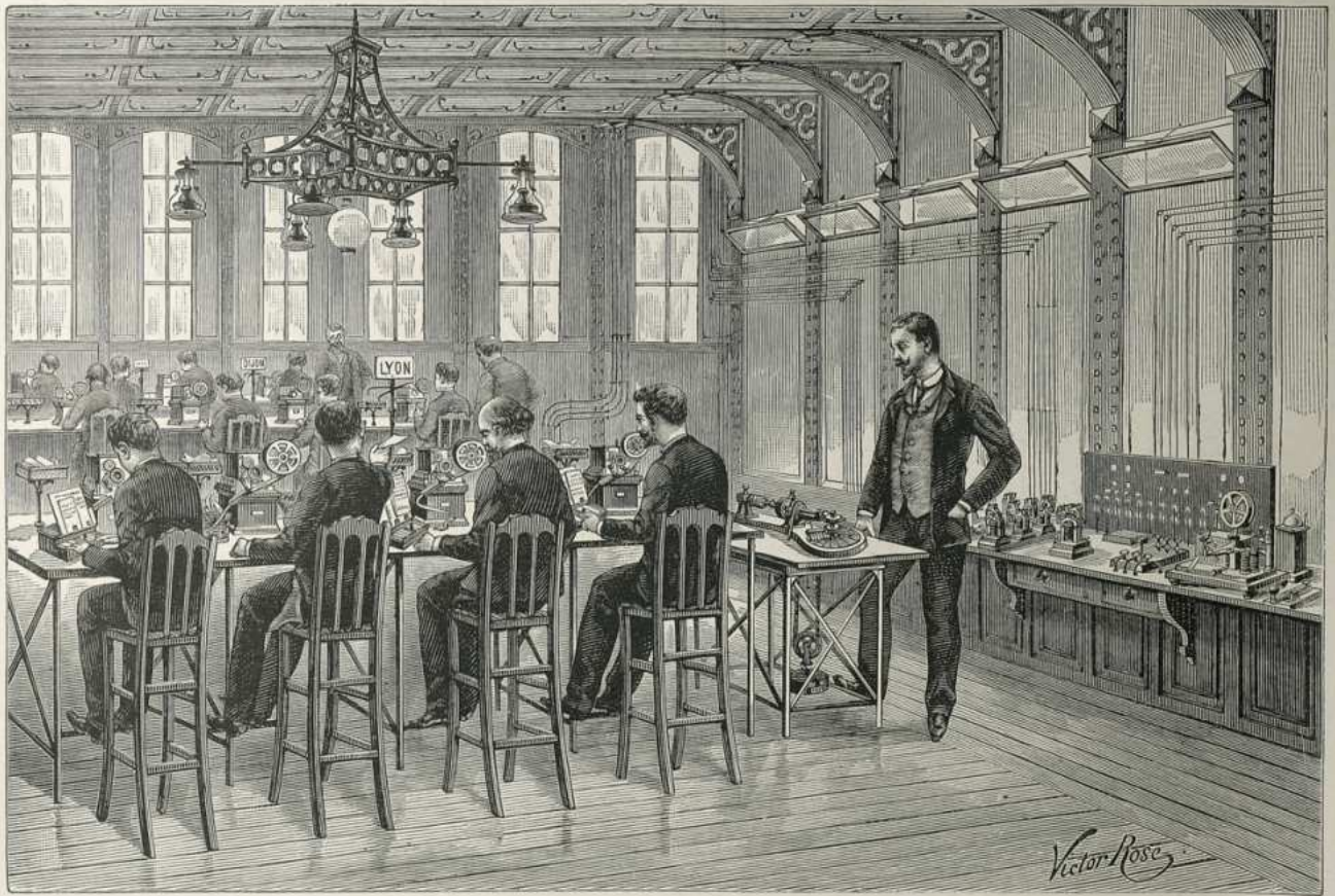
Fig. 2. — UN POSTE DU TÉLÉGRAPHE MULTIPLE BAUDOT, AU BUREAU CENTRAL DES TÉLÉGRAPHES DE LA RUE DE GRENELLE, A PARIS.
