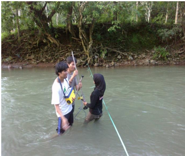
Pengukuran Kecepatan Aliran, Luas Penampang Sungai
