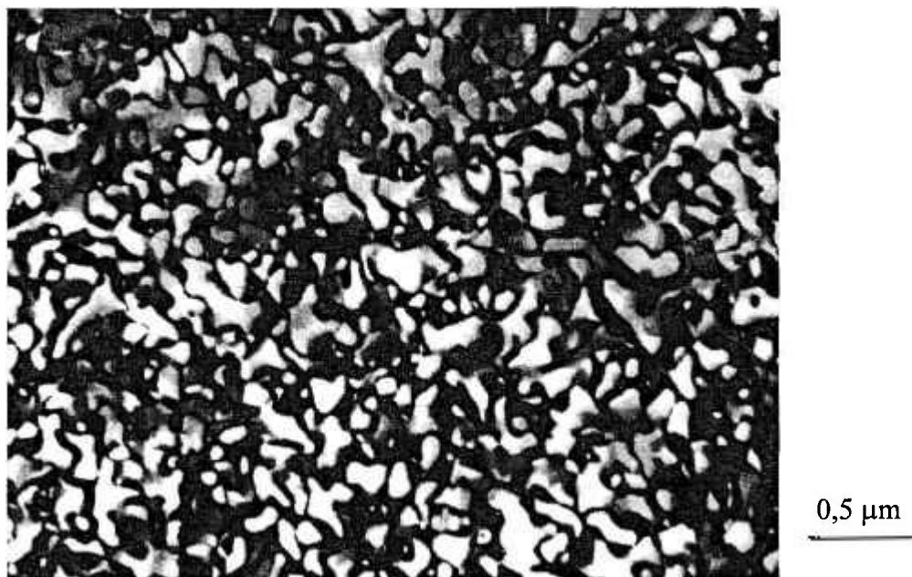
Figura 3.10: Microestrutura típica da liga Fe-30Al-0,15Zr-0,2B (%at.) laminada a quente (1000 °C) e tratada termicamente a 500 °C / 1 h, observadas em campo escuro a partir da reflexão (111) de estrutura ordenada D0_3 .
