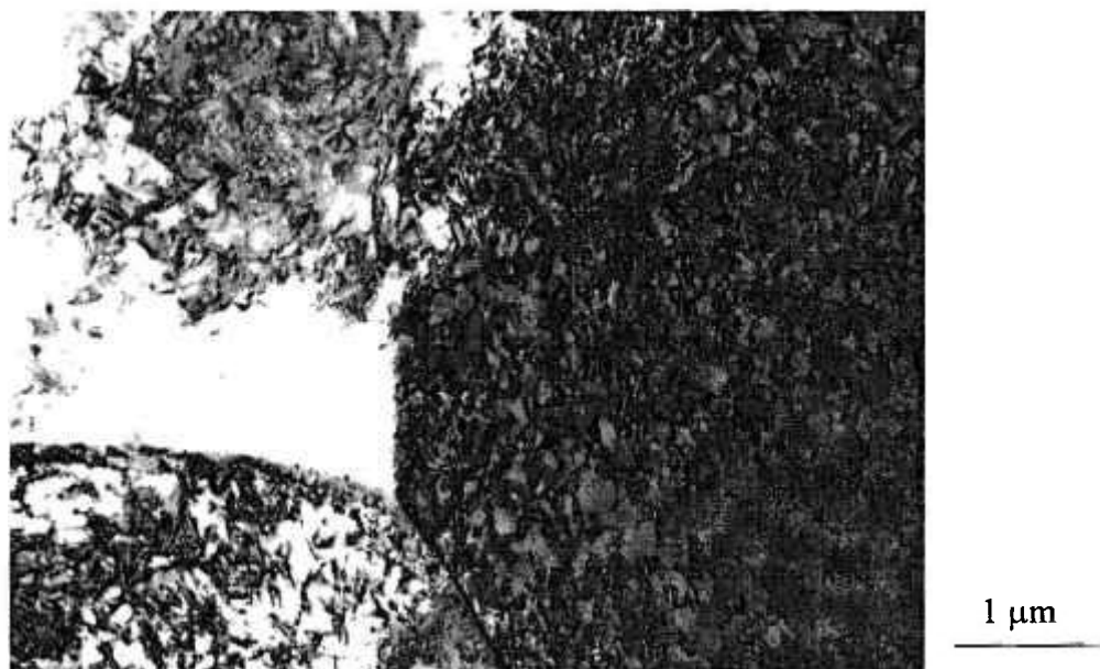
Figura 4.21: Microestrutura típica, observadas por microscopia eletrônica de transmissão, das amostras da liga M-1 (Fe-30Al-0,15Zr-0,2B sem cromo) no estado laminado a quente.
