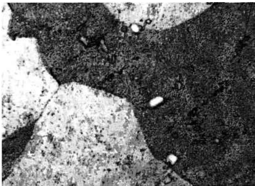
Figura 4.19: Detalhe da micrografia típica das ligas Fe-30Al-0,15Zr-0,2B-(0-4,5)Cr (%at.) laminadas a quente da figura 4.18A, onde observa-se uma segunda fase, provavelmente a peroviskita ( \text{Fe}_3\text{AlC} ).
