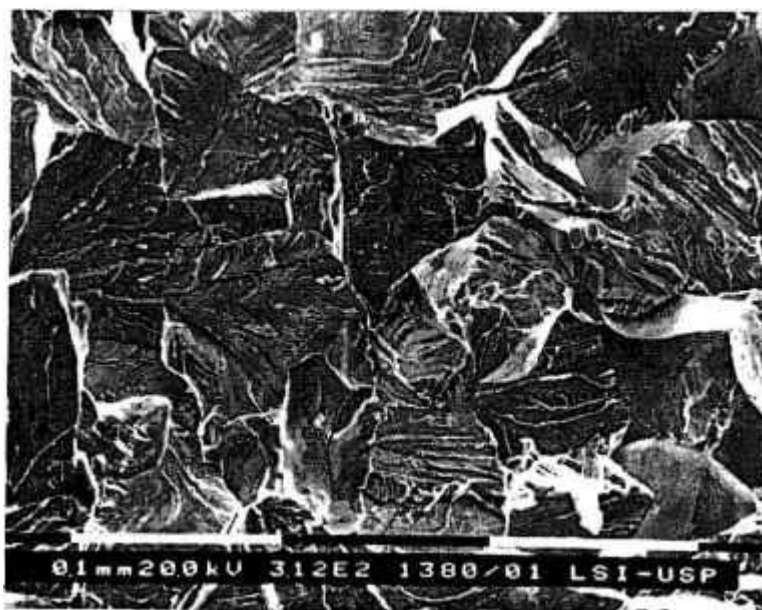
Figura 4.4: Superfície de fratura típica dos corpos de prova da liga Fe-24Al-2Cr (%at.) tratada termicamente na condição TT1 e ensaiados em tração a temperatura ambiente.
