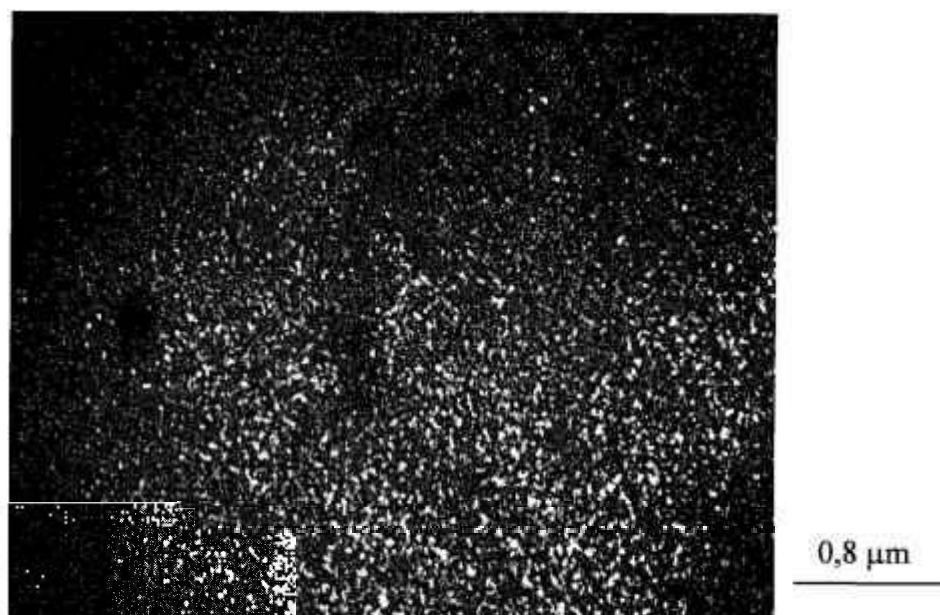
Figura 4.29: Micrografias típicas da liga M-4 (Fe-30Al-0,15Zr-0,2B-4,5Cr), tratada termicamente a 800 °C / 1 h, observada em campo escuro a partir da reflexão (111) do ordenado D0_3 .
