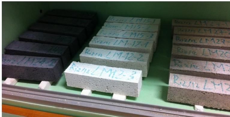
Figura 3.13 - Provetes de argamassa identificados e guardados em sala climatizada.
