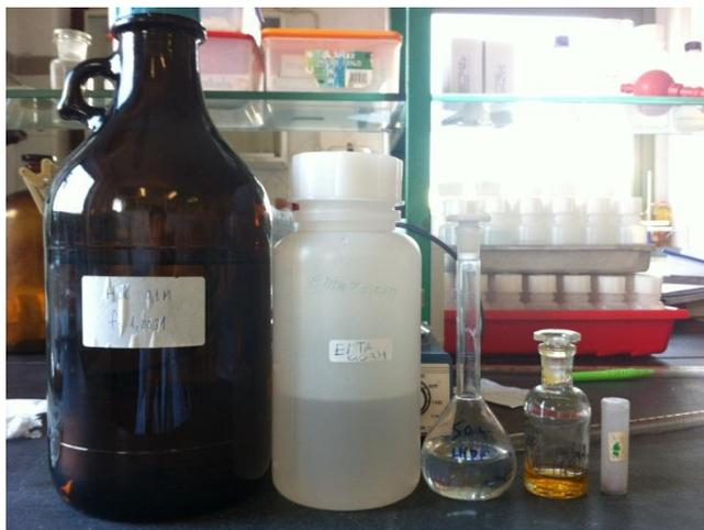
Figura 3.7 – Reagentes usados no ensaio de Fratini: HCl a 0,1M, EDTA a 0,03M, solução de hidróxido de sódio e indicadores de alaranjado de metilo e de calcon.
