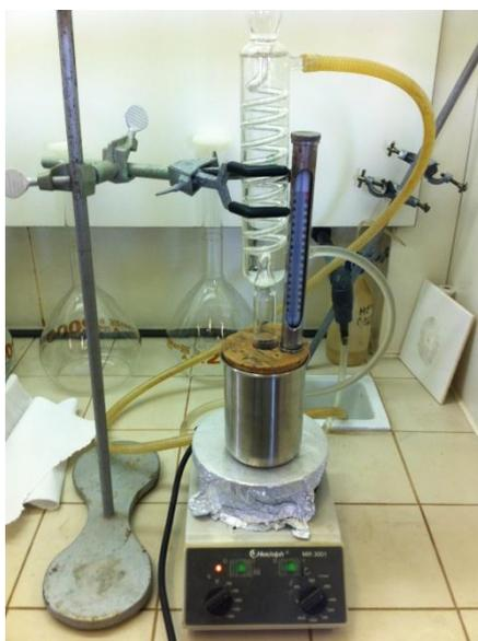
Figura 3.4 – Montagem do ensaio de Chapelle.
