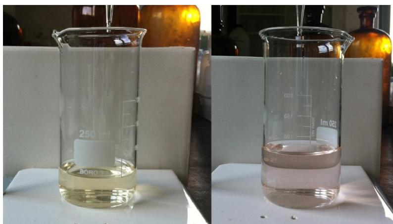
Figura 3.8 – Determinação da concentração de  $\text{OH}^-$  no ensaio de Fratini antes e após da titulação.
