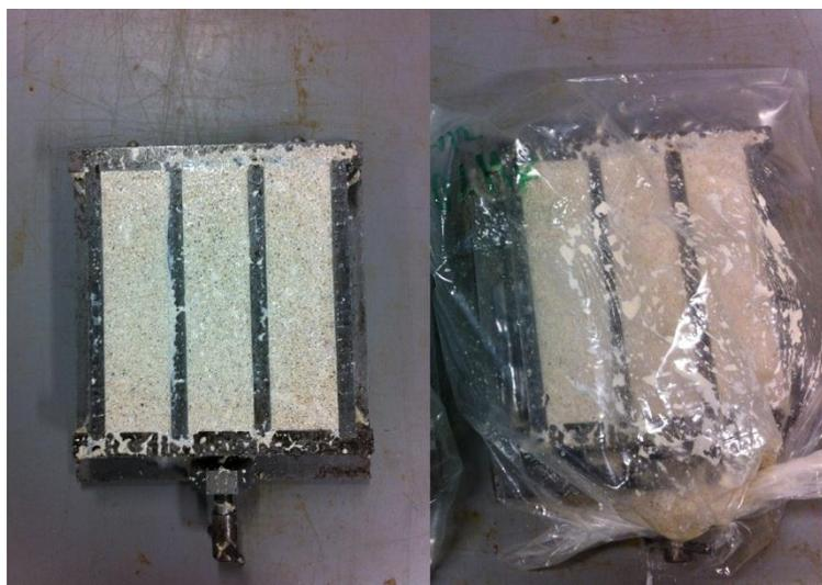
Figura 3.12 - Conservação do molde em saco de polietileno fechado.
