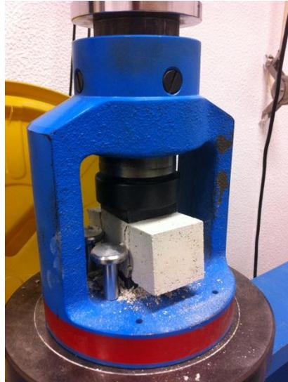
Figura 3.16 - Ensaio de resistência à compressão.
