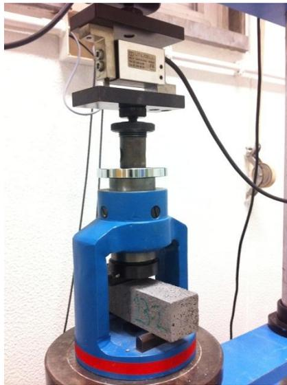
Figura 3.15 - Ensaio de determinação de resistência à flexão.
