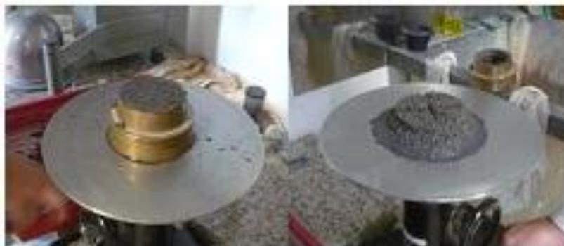
Figura 3.11 – Determinação da consistência por espalhamento: imagem antes e depois das 15 quedas.
