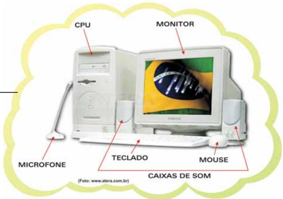
**CPU** – É uma sigla em inglês que significa Unidade Central de Processamento. É nela que estão instaladas as partes principais para o funcionamento do computador.
