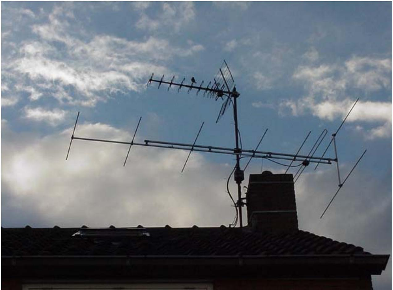
**Bild 1:** Die UKW-Antenne Hirschmann U8. Die Länge beträgt 3,41 m.
