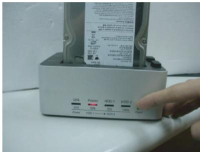
**ETAPE 4 :** Les 4 LED s'allument l'une après l'autre en orange pour indiquer la progression du clonage. Chaque LED orange correspond à 25 % du processus de clonage. La LED reste allumée jusqu'à ce que 25 % du disque dur 1 soit cloné vers le disque dur 2, la LED suivante s'allume ensuite à son tour. Lorsque l'opération de clonage est complètement terminée, toutes les LED clignotent en orange jusqu'à ce que l'appareil ait redémarré.
