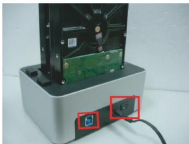
**ETAPE 3 :** Appuyez sur le bouton « Clone » et maintenez-le appuyé au minimum 5 secondes, la LED rouge « Power » s'éteint au démarrage de l'opération de clonage, et les 4 LED s'allument en orange.
