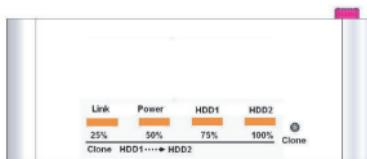
**NOTE : Si l'opération de clonage échoue, la LED du HDD 2 s'éclairera en rouge, les autres LED restant éteintes.**
