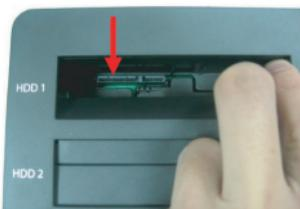
**Etape 2 :** Installez les disques durs HDD/SSD 2.5" et/ou 3.5" dans l'emplacement, en alignant le port avec le connecteur SATA.
