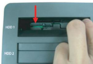
**Etapa 2:** Instale los discos duros HDD/SSD 2.5' y/o 3.5' en el espacio, alineando el puerto con el conector SATA.
