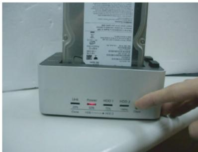
**ETAPA 4:** Las 4 LED se encienden una después de la otra en naranja para indicar el progreso de la clonación. Cada LED naranja corresponde a un 25% del proceso de clonación. La LED se queda encendida hasta que el 25% del disco duro 1 sea clonado en el disco duro 2. La LED siguiente se enciende entonces. Cuando la operación de clonación se termina por completo, todas las LED parpadean en naranja hasta que el dispositivo se reinicie.
