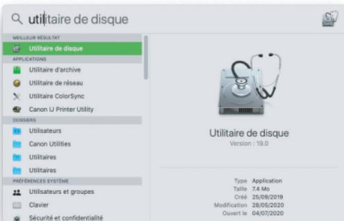
**ETAPE 3 :** Dans l'utilitaire de disque, sélectionnez le nouveau disque dans la barre à gauche. Il doit apparaître en « non initialisé » ou sans aucune partition. Puis cliquez sur « Effacer ».
