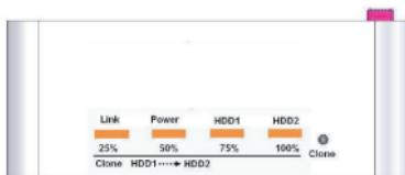
**NOTA:** Si la operación de clonación falla, la LED del HDD 2 se encenderá en rojo (las otras LED se mantienen apagadas).
