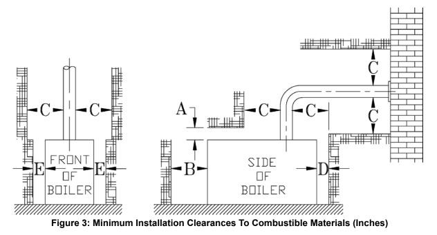
С В Chimney D Е А Above Front Connector Rear Sides 6 24 18 6 6
