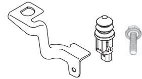
Contacteur de sécurité du capot, support et boulon
