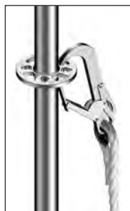
Fig. 26: Es posible la conexión en el agujero grande o pequeño de la roseta. (Solo válido para el modelo en acero, no para el de aluminio)
