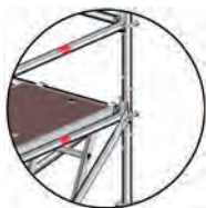
Fig. 84: Unión de verticales con espigas atornilladas
