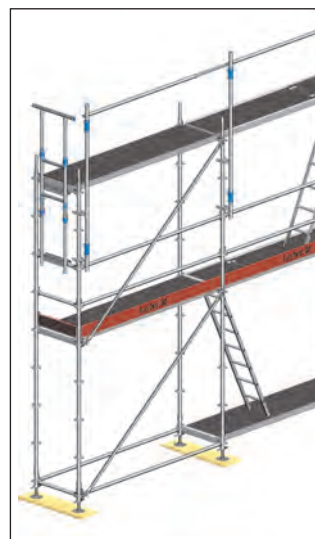
Fig. 31: Barandilla lateral de montaje colocada
