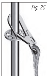
Fig. 26: Es posible la conexión en el agujero grande o pequeño de la roseta. (Solo válido para el modelo en acero, no para el de aluminio)
