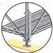
Fig. 82: Aseguramiento de base con cabeza con cuña
