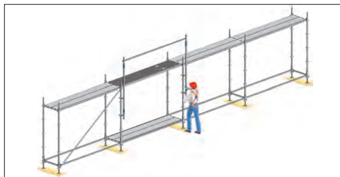
Fig. 37: Utilización de la barandilla de montaje en el modulo de acceso.
