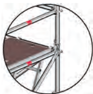
Fig. 83: Unión de barras con pasadores
