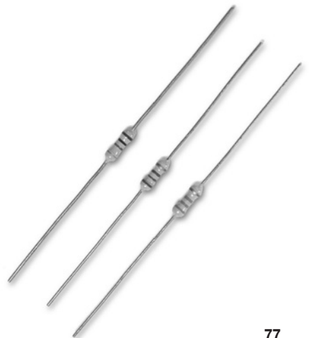
Figura 7. Los resistores de carbón tienen bandas impresas en su cuerpo para indicarnos su valor y tolerancia.
