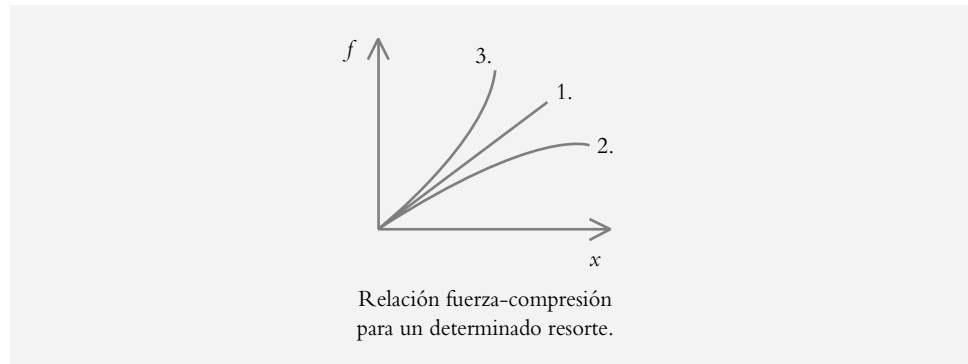
Figura 3.45 Comportamiento de un resorte: 1. Resorte lineal. 2. Resorte ablandado. 3. Resorte endurecido.
