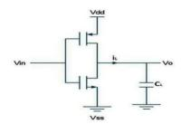
Figure 25. CMOS Inverter
