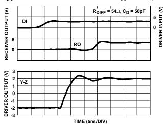
FIGURE 14. DRIVER AND RECEIVER WAVEFORMS
