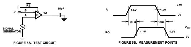
FIGURE 5. RECEIVER PROPAGATION DELAY
