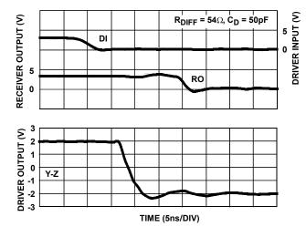
FIGURE 15. DRIVER AND RECEIVER WAVEFORMS
