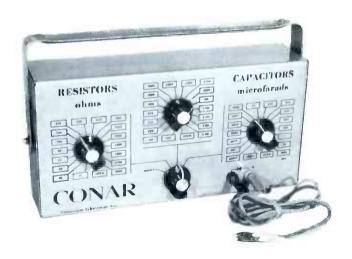
FIGURE 2. THE MODEL 201 COMPONENT SUBSTITUTION BOX.
