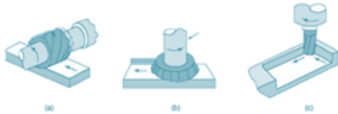
Gambar 2.2. Tiga Klasifikasi Proses Frais : (a) Frais Periperal ( Slab Milling ), (b) Frais Muka ( Face Milling ), (c) Frais Jari ( End Milling ).
