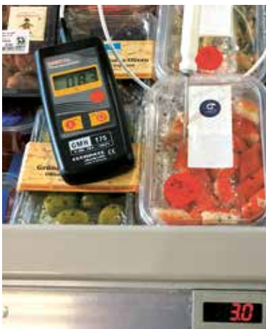
Abb. 6.2.8: Messung der Produkttemperatur durch die Lebensmittelkontrolle, wobei die Temperaturanzeige des Kühlgerätes 3.0°C anzeigt, die effektive Produkttemperatur aber 8.3°C beträgt.
