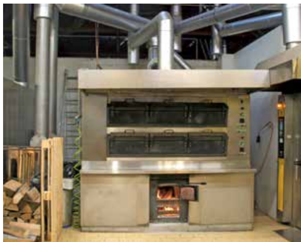
Abb. 6.2.1: Klassischer Holzofen ohne Einsatz von Thermo-Öl
