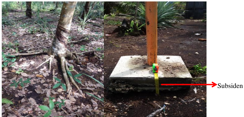
Gambar 4. Perakaran yang muncul di atas permukaan lahan sebagai indikasi terjadinya subsiden di lahan gambut (kiri) dan tingkat subsiden selama 2 tahun (kanan) (Foto: Ai Dariah dan Maswar)
