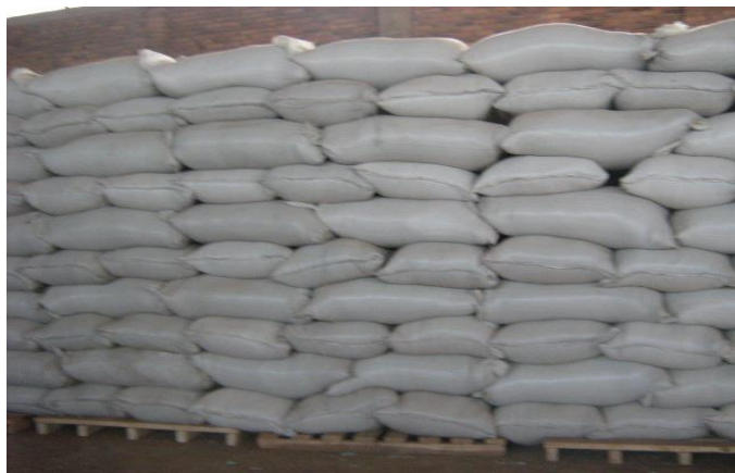
Gambar 55. Penumpukan dengan Sistem Staffel (Dokumentasi Tutik Nuryati, 2013)
