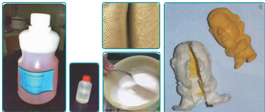
(Sumber: Dokumen Kemdikbud) Gambar 2.8 Bahan resin, katalis, mett fiber, silikon, dan cetakan
