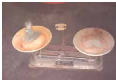
Timbang warna Indigosol Blue O 4 B dengan berat 10 gr.
