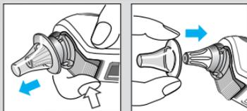
6. Remplacez l'embout jetable après chaque mesure : Pour ce faire, appuyez sur le bouton « éjection » et fixez un nouvel embout propre.
