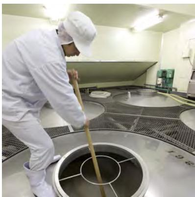
Il *sake* grezzo viene mescolato per abbassare il tenore di anidride carbonica. Controllare lo stato della fermentazione è un lavoro importante del capo cantina.
