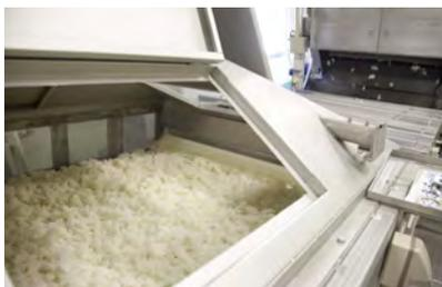
Il processo per la creazione del *koji*, indispensabile per la produzione del *sake*. Si fanno riprodurre i batteri nel riso cotto al vapore per circa due giorni tarando la temperatura di cottura.
