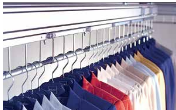
Transportadores suspendidos de Dürkopp
