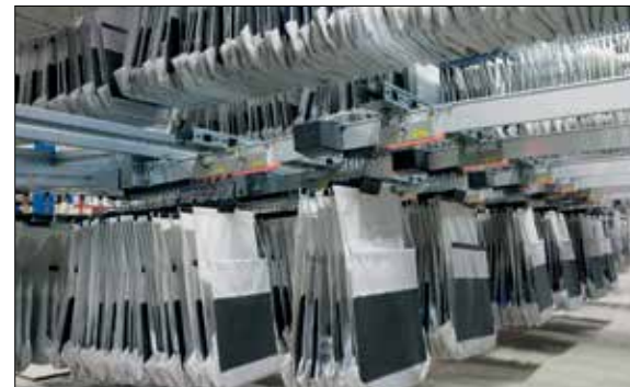
Sistema de clasificación en bolsas colgadas patentado de Dürkopp
