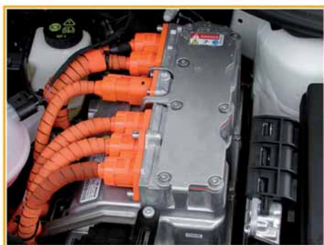
Électronique de puissance et de commande pour transmission électrique JX1
