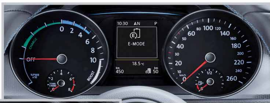
Combiné d'instruments avec indicateurs spécifiques GTE
