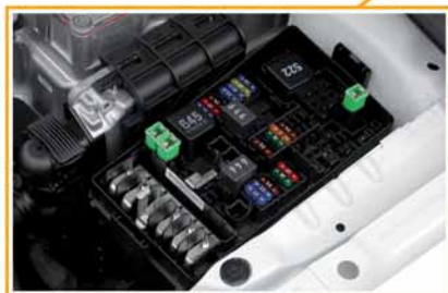
Boîtier électrique avec porte-relais et porte-fusibles SB et porte-fusibles Multifuse SA dans le compartiment-moteur, à côté de l'électronique de puissance et de commande JX1.
