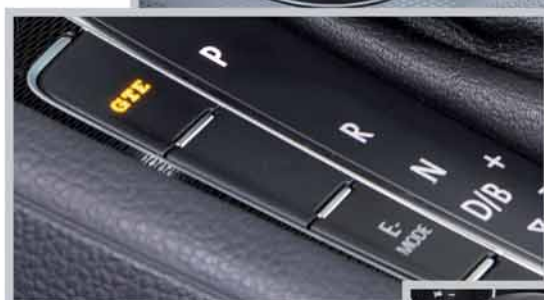
Touche pour programme sport (mode GTE) et touche pour propulsion électrique (E-MODE) à côté du levier sélecteur
