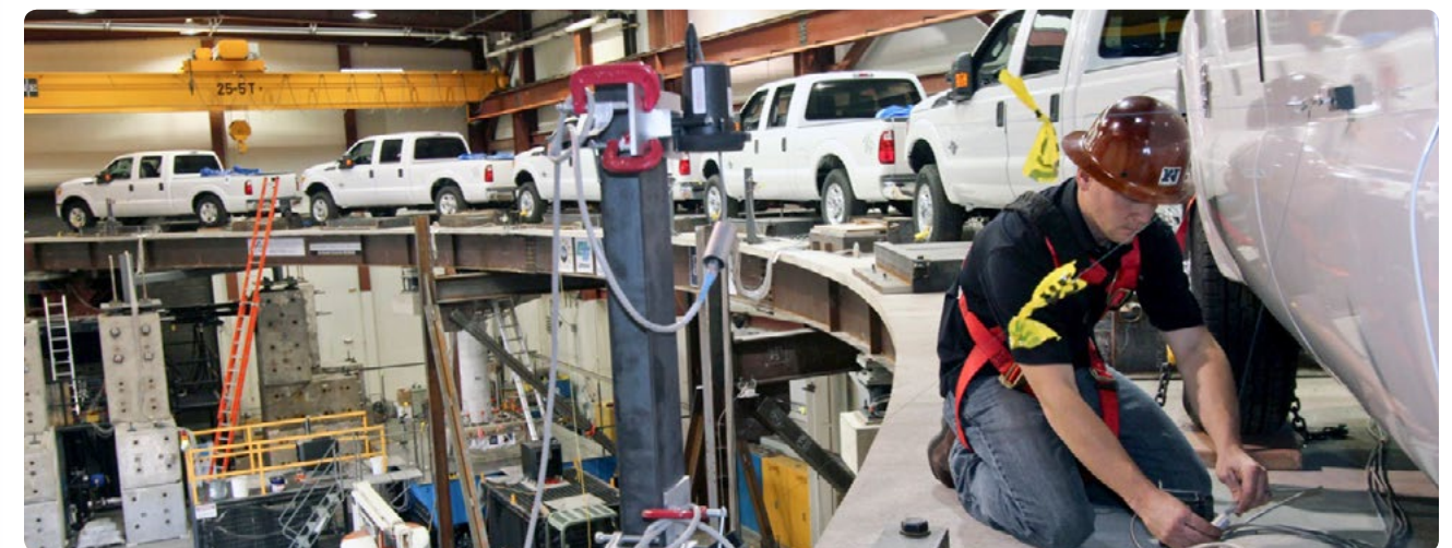
Investigadores en University of Nevada, Reno, agregan instrumentos al modelo de puente de escala completa en su laboratorio de prueba sísmica.
