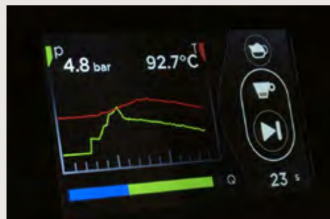
Tecnologia Multiboiler con abbinamento curve di temperatura a profili di pressione. Multiboiler technology using combination of temperature and pressure profiling.
