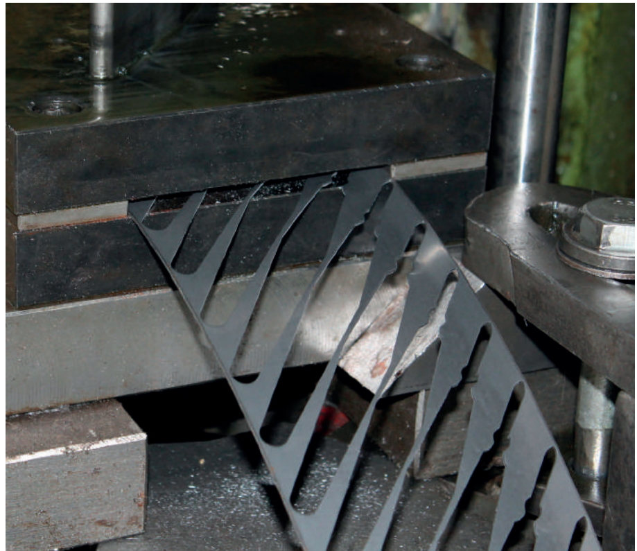
Cutting the spatulas from a stainless steel sheet. Tranciatura delle spatole da un nastro di acciaio.
