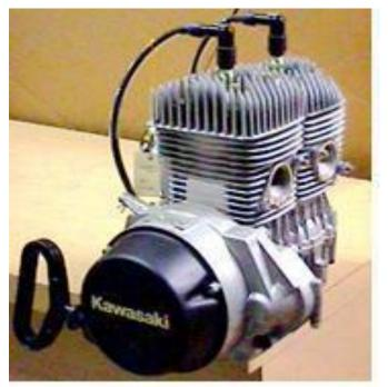
Fig: Air Cooling System
