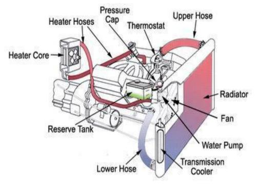
Fig: Liquid Cooling System
