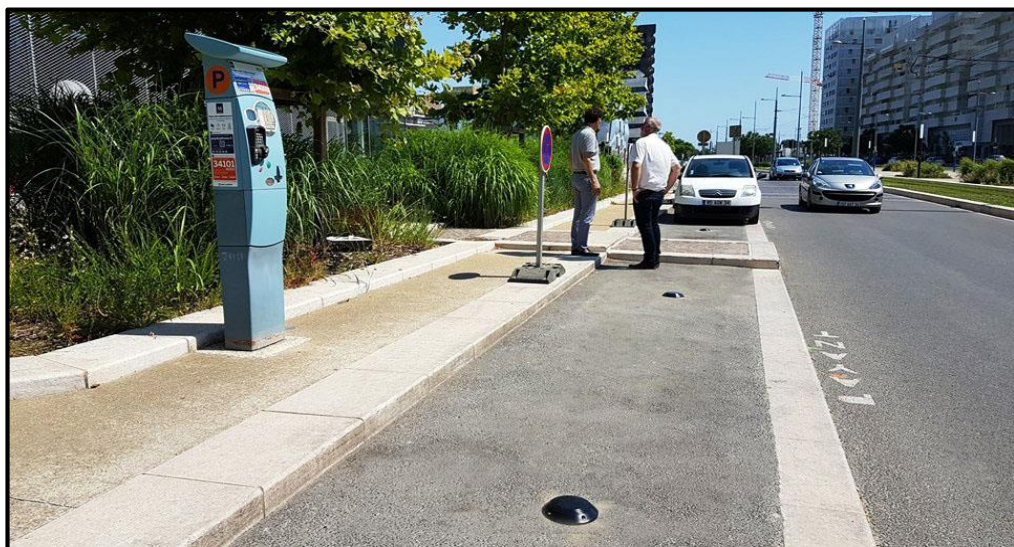
Rajah 2.12 : Contoh plat Connected Parking dipasangkan di atas permukaan jalan raya. (Sumber : Libelium, 2012)
