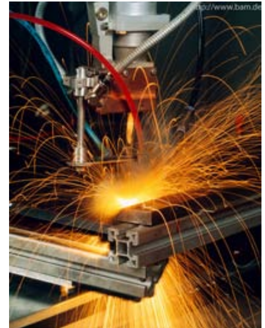
Schweißen, 20-kW-Faserlaser, BAM Fachbereich 9.3 Schweiß- technische Fertigungsverfahren
