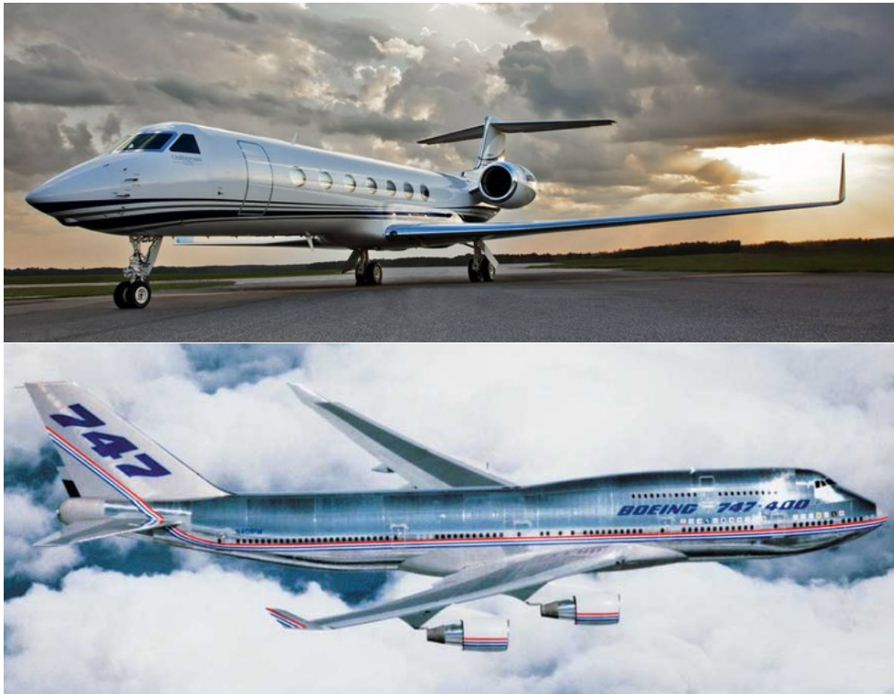
Gulfstream (au dessus) et Boeing 747-400 (en dessous) tous deux munis de winglets
