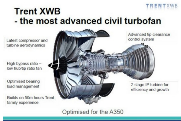
Réacteur de l'A350 «le plus avancé des réacteurs civils»
