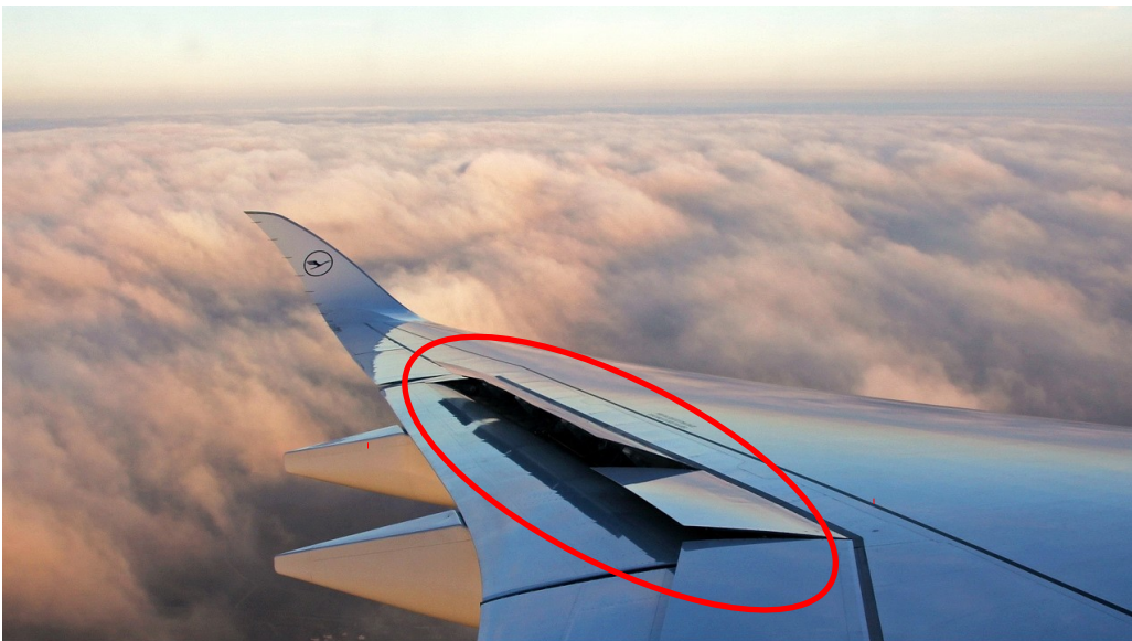
Système de contrôle actif de l'écoulement de l'air en action sur l'A350 XWB
