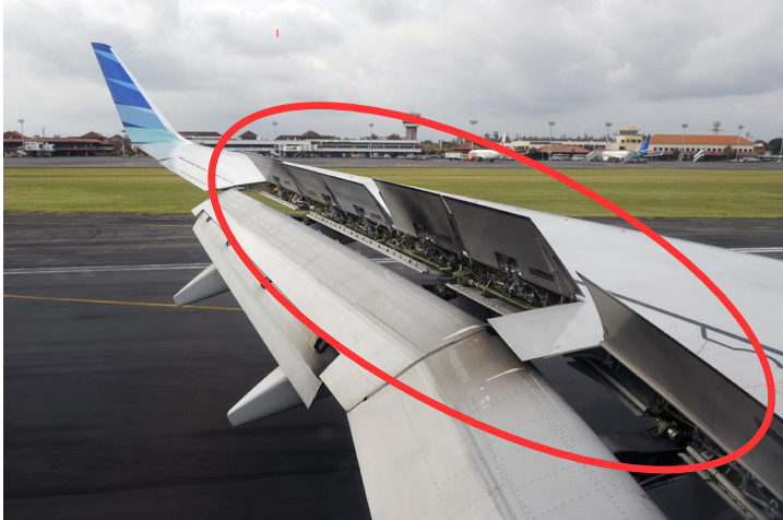
Aérofreins sur l'extrados d'un Boeing 737-800
