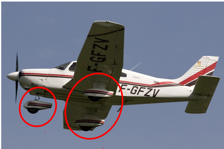
Train d'atterrissage fixe-caréné sur un Piper PA28
