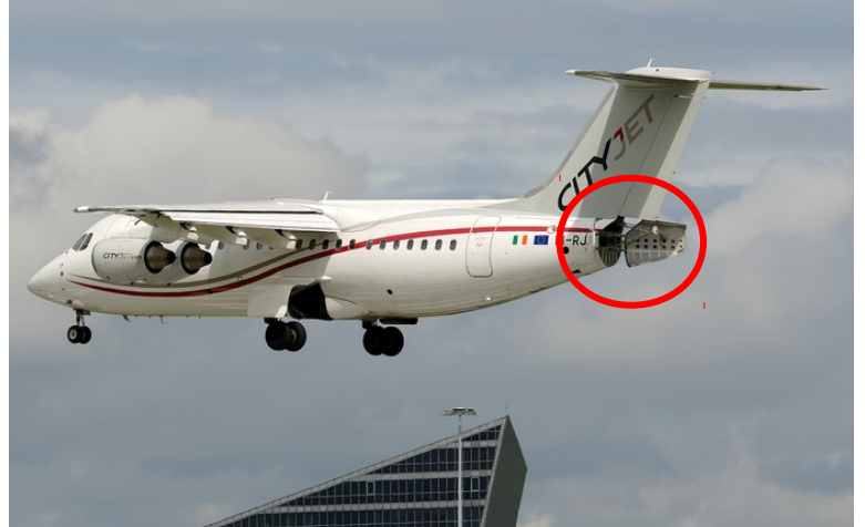
Aérofreins sur le cône de queue d'un BAe 146-300
