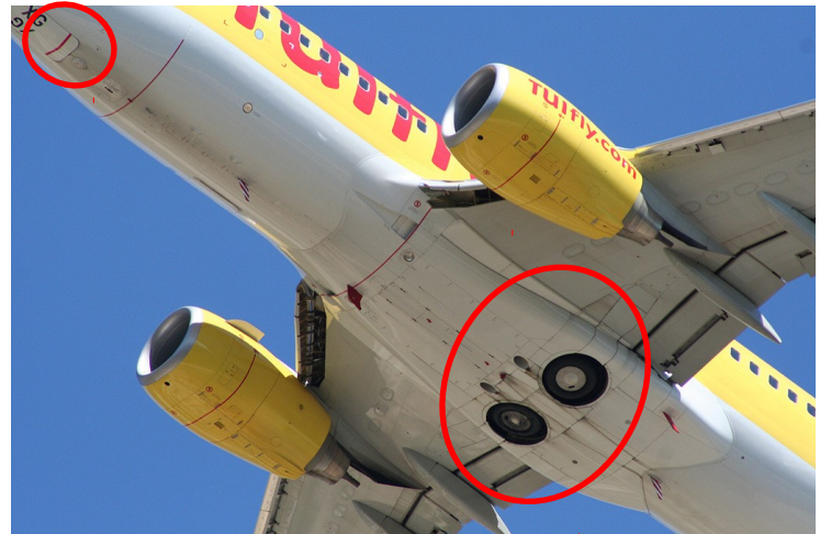
Train d'atterrissage rétractable sur un Boeing 737-800
