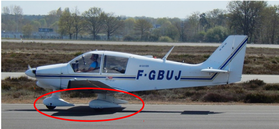
Carénage de train d'atterrissage sur un avion de type Robin DR400-120
