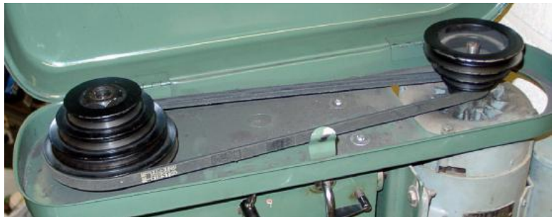
Image 5.15 – entraînement de la broche par poulie
