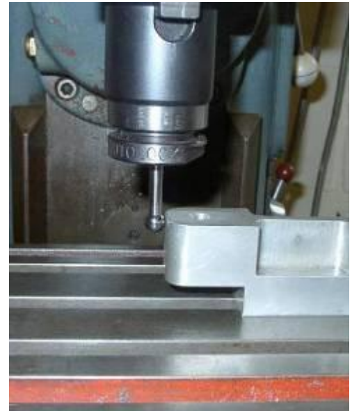
Le chiffre 7.12 - chercheur de Bord en cours d'utilisation sur une fraiseuse
