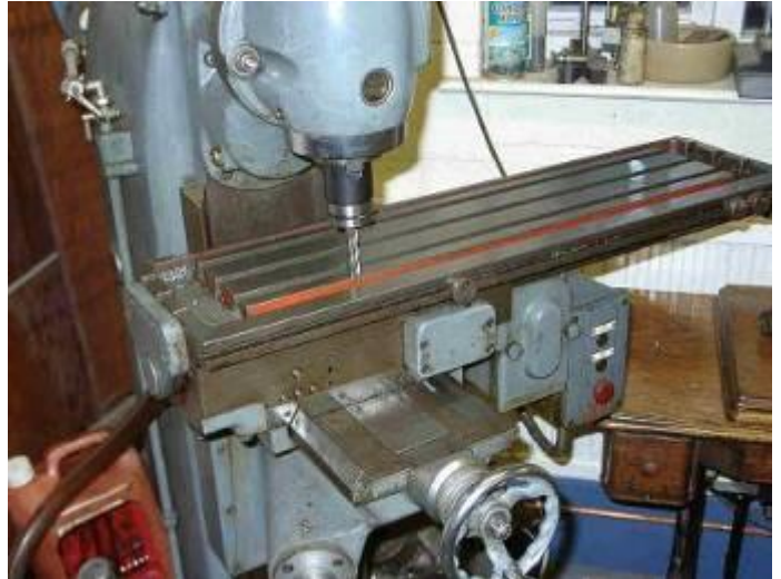
Image 4.10 – fraiseuse avec l'outil à la position x=0 et y=0 (Remarquez le rouleau en butée sur le contact)
