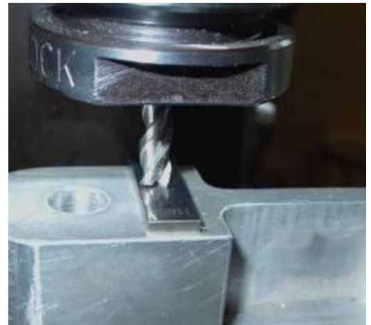
Image 7.10 - Utilisation d'une cale pour régler la compensation Z sur une fraiseuse
