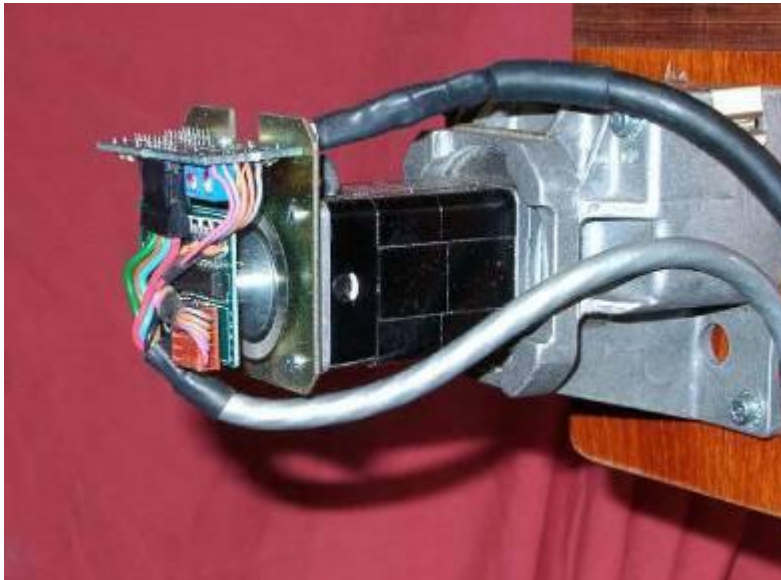
Image 4.3 – petit servomoteur avec un encodeur (à gauche) et un démultiplicateur (à droite).
