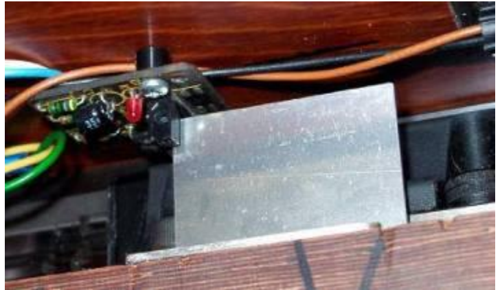
Image 4.8 – contact Optique monté sur la table
