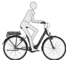
Figure 1.2 : réglage de la hauteur de la selle
