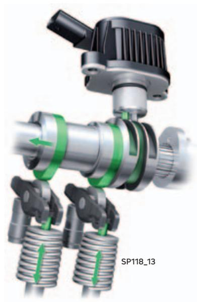
Calage des cames lors du régime des quatre cylindres, les soupapes travaillent avec la même course comme les soupapes des cylindres placés aux cotés extrêmes
