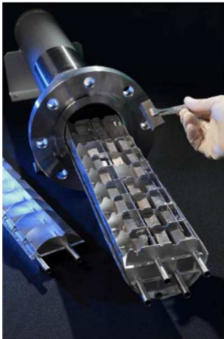
Un réservoir de stockage d'hydrogène sous forme d'hydrures métalliques de conception Liten. © P.Avavian/CEA
